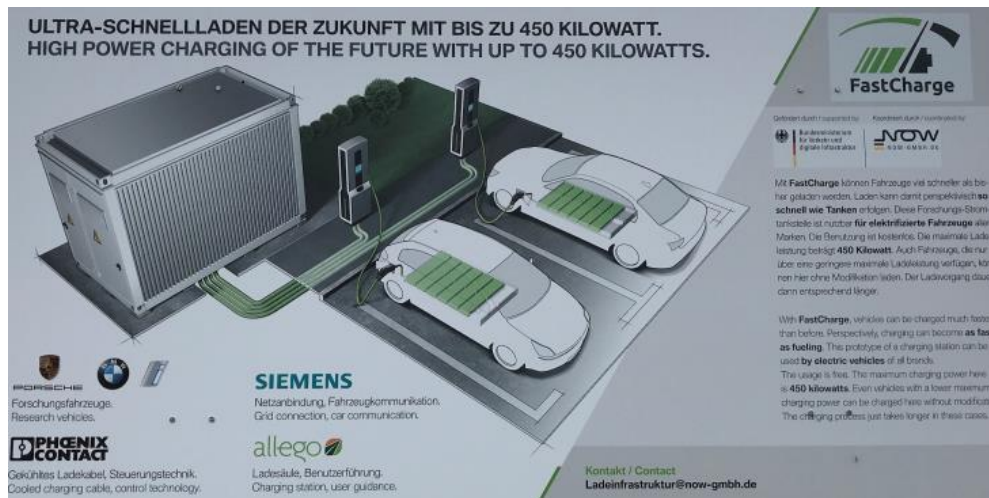
Obrázek 19: Schéma nabíjecí stanice o výkonu 450 kW [14]
